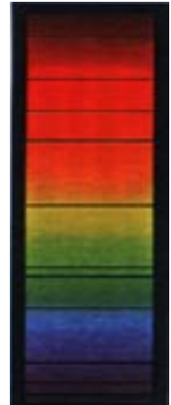
Abb. B. Sonnenlichtspektrum mit Fraunhoferschen Linien, welche man mittels eines Prismas und eines Mikroskopes, oder Fernrohres, gut beobachten kann.
